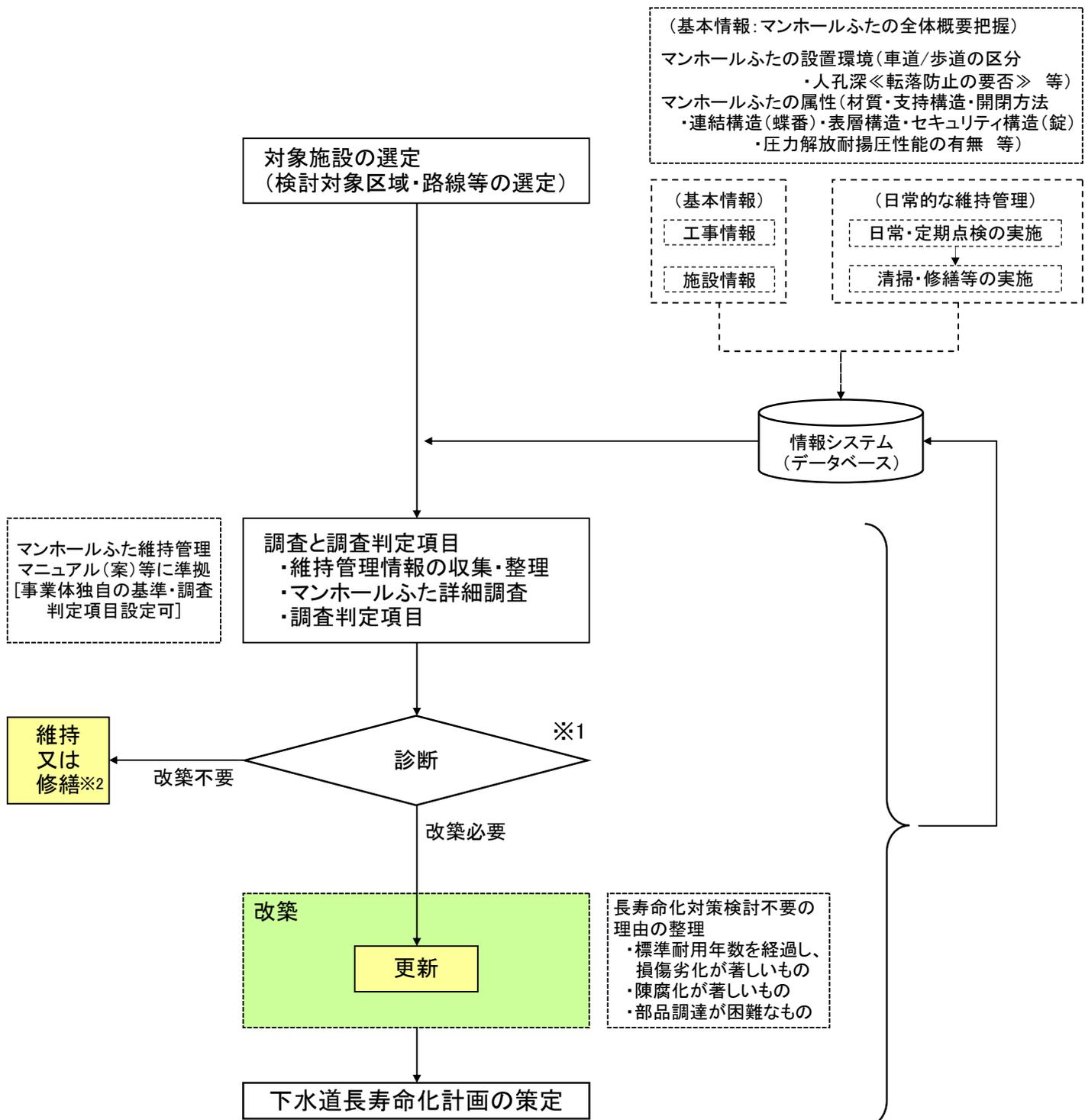
※1 マンホールふたの診断は、損傷劣化による判定に加えて、設置基準による判定により、現在の設置環境に不適合となっているものの抽出が重要。
