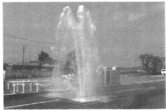
豪雨時のマンホールふた浮上・飛散を体験
