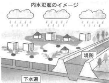
雨量が下水道などの排水能力を超え、浸水被害が発生
