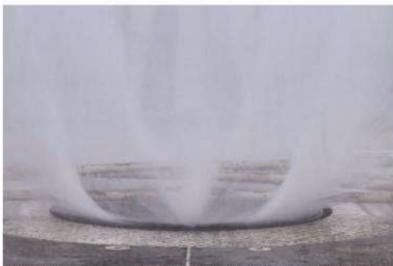
図4 フタが外れないようにしつつ、マンホール内の圧力を逃がす工夫 (日本グラウンドマンホール工業会提供)
