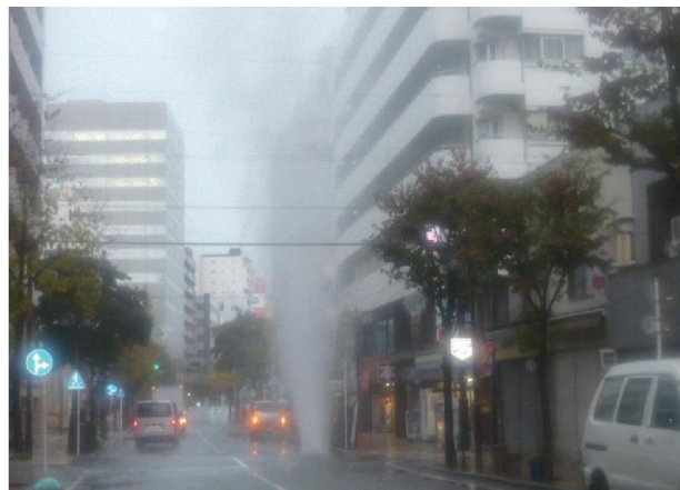
内圧による蓋の浮上飛散 ⇒ 事故
