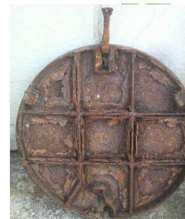
腐食 ⇒ 蓋の強度低下・開閉不能・錠・蝶番欠落
