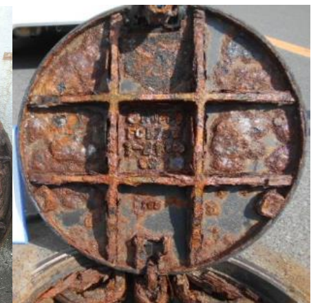
腐食 ⇒ 蓋の強度低下・開閉不能・錠・蝶番欠落
